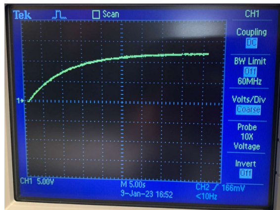
Figuur 5: Een foto van de RC laadcurve dat is vastgesteld door een oscilloscoop (1 blokje = 5 seconden).
