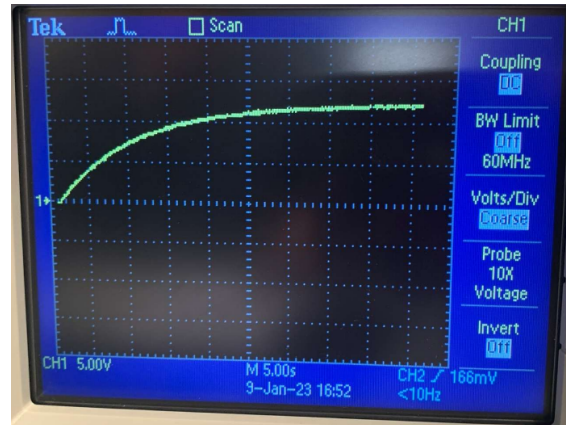
Figuur 6: Een momentopname van de RC laadcurve dat is vastgesteld door een oscilloscoop.
